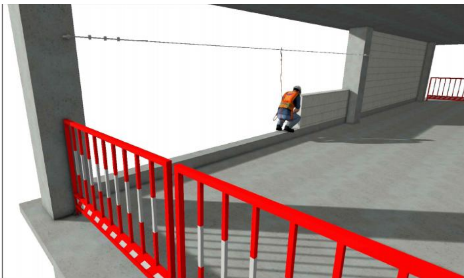
砌体工程生命线设置示意图
